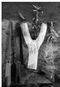
Sgrossatura preliminare della forcella.
